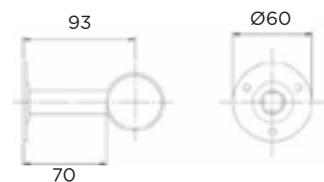
**CONEXIÓN TUBO · TUBE CONNECTIONS · TUBE DE CONNECTION**
